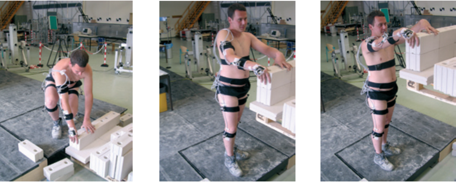
Figuur 2d,e,f. Een blokkensteller tijdens de taak neerzetten laag, midden en hoog in de wand in het laboratorium.
